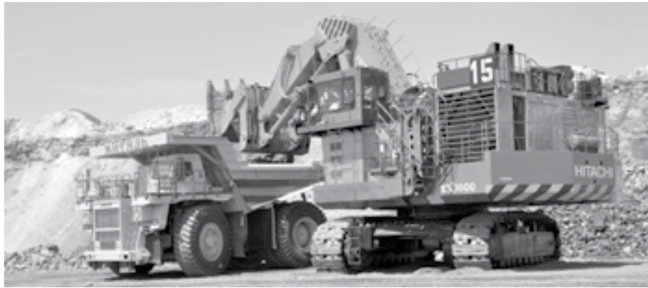
Hitachi EX3600-6 – первый гидравлический экскаватор на Ингулецьком ГОКе, имеющий такой объем ковша – 15,5 м³. С 2008 г. в карьере уже эксплуатируются две единицы данного производителя с меньшим объемом ковша.
